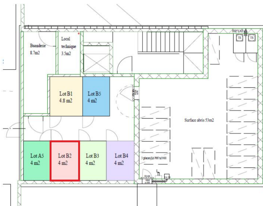
Sous-sol, bâtiment Est – caves et abri PC
