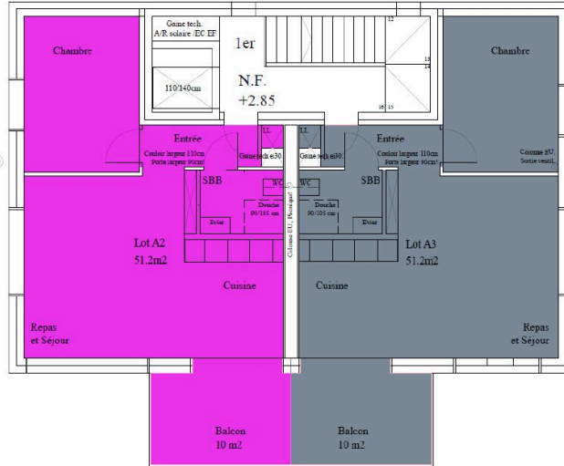
1 er étage, lots A2 et A3 – bâtiment Ouest
